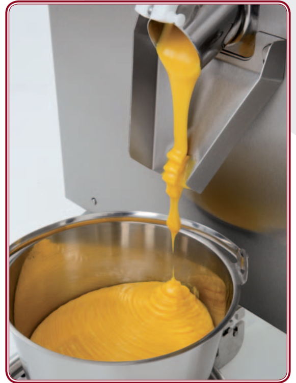
Rubinetto d'estrazione con comando elettronico Electrically controlled outlet tap
